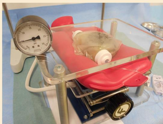
4. Les 4 diffuseurs à coque souple ont répondu au test de résistance à la pression
