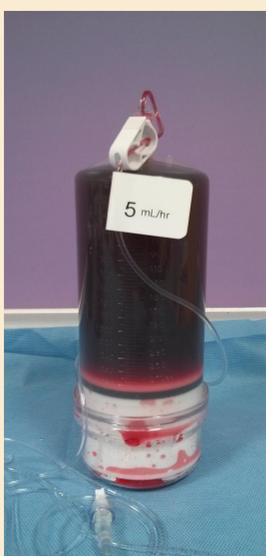
2. Trois diffuseurs dont 1 du fabricant A et 2 du fabricant C n'ont pas répondu à l'essai de chute
