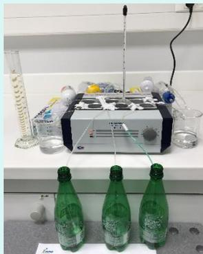
Afin de se rapprocher des conditions d'utilisation, le régulateur de débit a été thermostaté à 37°C à l'aide d'un bloc chauffant Techne® alors que le corps du diffuseur demeurait à température ambiante 22,7°C.
