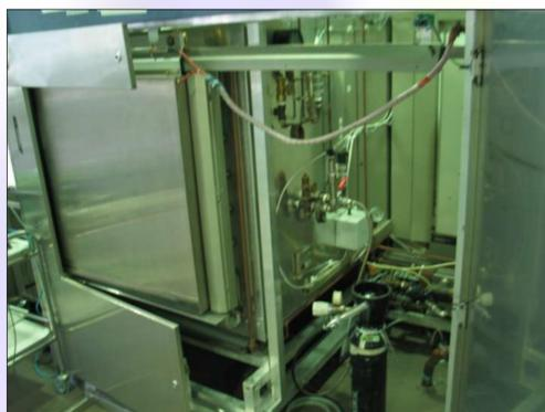
En jouant sur les temps et sur les débits d'injection, différents volumes d'air (0.10, 0.15, 0.25, 0.50, 0.75, 1L) ont été injectés dans la cuve lors de la phase de montée au plateau de stérilisation.
