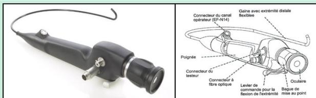
Figure 1 : Fibroscope ORL Souple
