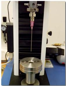
**Définition de la force de pénétration :** Force nécessaire au biseau pour traverser la membrane.
