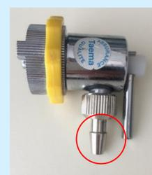
Embout mâle du filtre de trop petit calibre : la tubulure de vide est en butée sans maintien.
