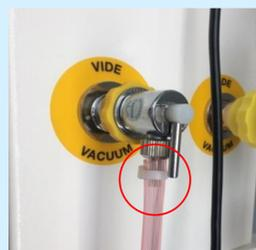
Lien de serrage en plastique placé de manière à maintenir le montage tubulure/filtre en place.
