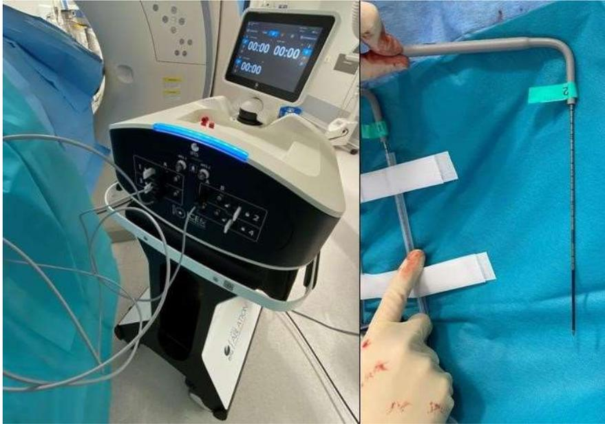
Figure 5 : Générateur et dispositif Galil® (Boston) d'ablation par cryothérapie
