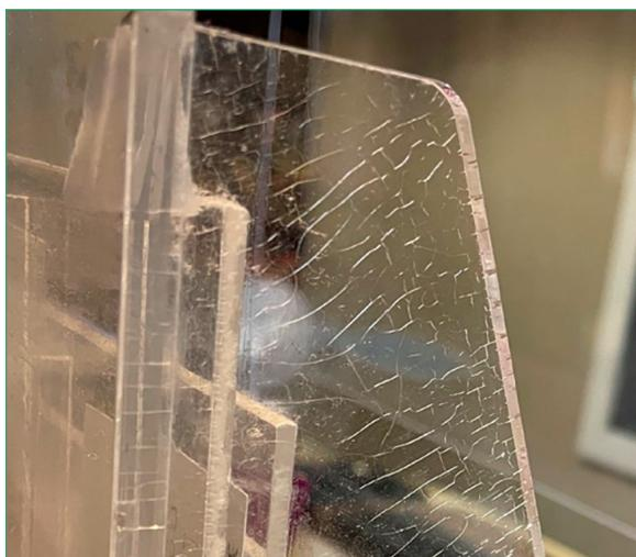
**Figure 3** – Exemple de fissuration due à l'« *environmental stress cracking* » sur une plaque en polymère, d'après Buchanan T<sup>[6]</sup>.
