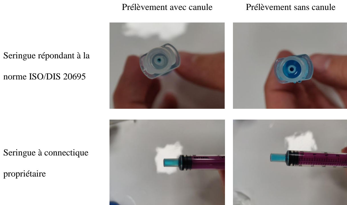
Figure 1 : Volume mort visible dans les seringues répondant à la norme ISO/DIS 20695 et dans les seringues à connectique propriétaire en fonction de la méthode de prélèvement (avec ou sans canule).
